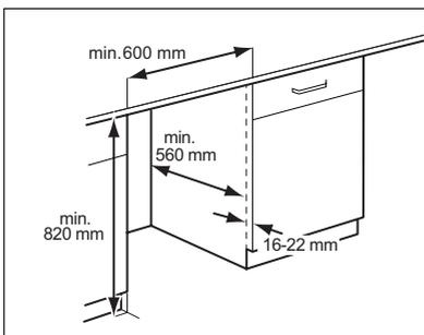
Dieses Gerät lässt sich in eine Einbauküche integrieren. Siehe die minimalen Abmessungen der Nische in den Zeichnungen.
