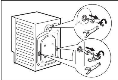
6. Entfernen Sie die drei Schrauben, die Schlauchhalter und Kunststoff-Distanzstücke mit dem mitgelieferten Schlüssel.
