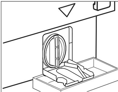
**2.** Stellen Sie einen geeigneten Behälter unter die Öffnung der Ablaufpumpe, um das abfließende Wasser aufzufangen. Halten Sie beim Herausnehmen des Siebs einen Lappen bereit, um austretendes Wasser aufzuwischen.
