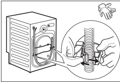
5. Nehmen Sie das Netzkabel und den Ablaufschlauch aus den Schlauchhalterungen.
