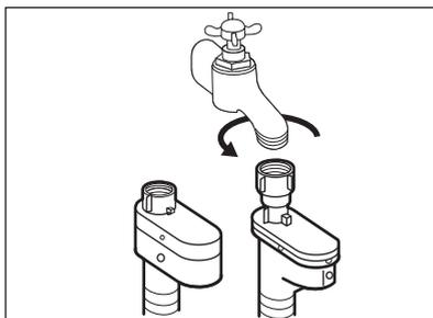
5. Schließen Sie den Wasserzulaufschlauch an einen Kaltwasserhahn mit einem 3/4"-Außengewinde an.
