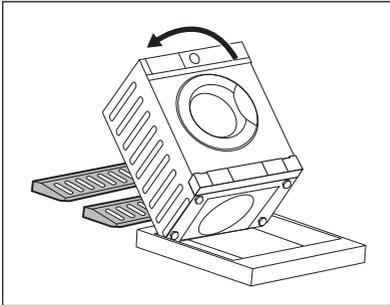
1. Legen Sie die beiden Styroporsteile unter dem Gerät auf den Boden.
