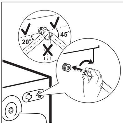
3. Schließen Sie den Wasserzulaufschlauch an der Rückseite der Maschine an. Drehen Sie den Zulaufschlauch nicht nach unten, sondern nach links oder rechts, je nach Position Ihres Wasserhahns.
