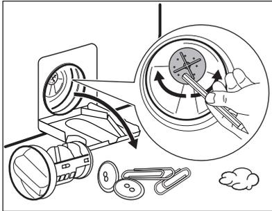
**7.** Entfernen Sie gegebenenfalls Flusen und Fremdkörper aus der Siebaufnahme. Prüfen Sie, ob sich das Flügelrad der Pumpe drehen lässt. Ist dies nicht möglich, wenden Sie sich an den autorisierten Kundendienst.
