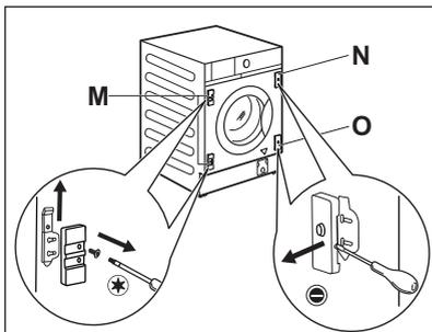
Soll sich die Verkleidungstür von links nach rechts öffnen, vertauschen Sie die Position der Scharnierträger **M** und der Magnetplatte **N** und unteren Platte **O**.
