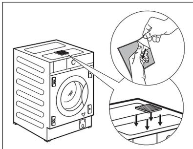
Das Gerät besitzt auch ein selbstklebendes Schwammkissen **H**, das sich in der Trommel befindet.
