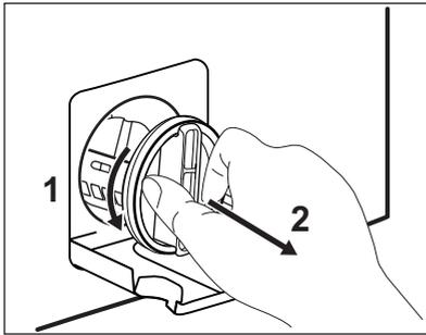
**6.** Drehen Sie das Sieb gegen den Uhrzeigersinn, um es zu entfernen
