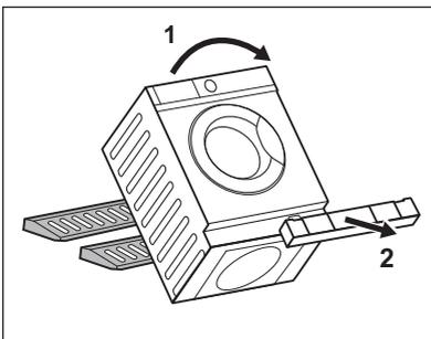
4. Bringen Sie das Gerät in die senkrechte Position und entfernen Sie den Styroporschutz aus dem Sockel.
