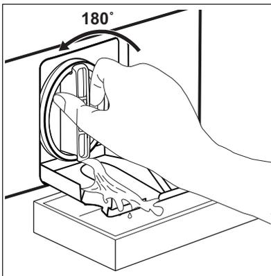
**3.** Drehen Sie das Sieb um 180 Grad gegen den Uhrzeigersinn, um es zu öffnen und entfernen Sie es nicht. Lassen Sie das Wasser ablaufen.
