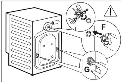
7. Verschließen Sie die Löcher mit den Kunststoff-Kappen, die sich im Beutel mit der Bedienungsanleitung befinden. Setzen Sie die kleinste Kappe **F** in das obere Loch und die beiden größeren Kappen **G** in die unteren Löcher ein.
