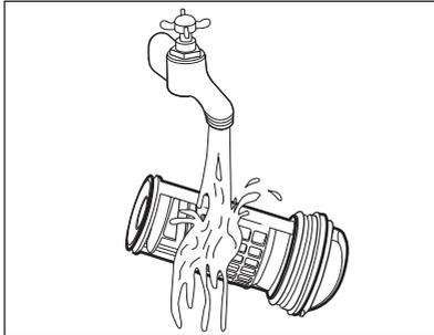
**8.** Reinigen Sie das Sieb unter fließendem Wasser.
