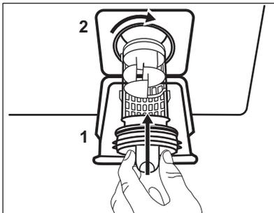
**9.** Setzen Sie das Sieb wieder in die dafür vorgesehenen Führungen ein und drehen Sie es im Uhrzeigersinn. Achten Sie darauf, dass Sie das Sieb richtig fest anziehen, um Wasserlecks zu vermeiden.
