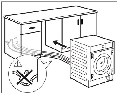
Stellen Sie vor Beginn des Einbaus das Gerät in die Nähe der Nische und schließen Sie den Zulaufschlauch, den Ablaufschlauch und das Netzkabel bereits an.
