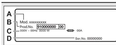
Das **Typenschild** gibt den Modellnamen (A), die Produktnummer (B), die elektrischen Nennwerte (C) und die Seriennummer (D) an.
